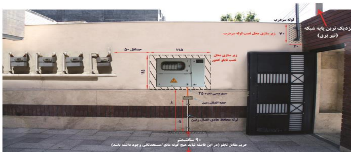
شکل ۱: موقعیت نصب تابلو کنتور فلزی
